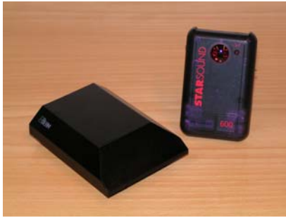
Figur 7: Infrarøde modtagere er et alternativ til teleslynger og FM-anlæg. De kan fås med halsteleslynge, så signalet fra IR-modtageren opfanges af høreapparatets telespole (billede af PhonicEAR Logia BEAM IR system).
