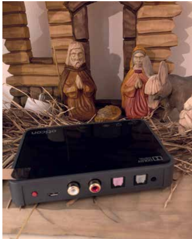
Her et eksempel på en æske, der kan overføre bredbåndslud i stereo fra f.eks. TV direkte til ens høreapparater
