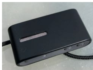
Partnarmikrofonen gives til den, man vil tale med, og den sender talelyden trådløst ind i høreapparatet hos den hørehæmmede – også gennem et visir!
